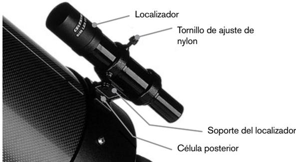
2. Pase parcialmente los tres tornillos de nylon que aguantan el localizador en posición dentro del soporte. Apriete los tornillos hasta que los cabezales de nylon estén ajustados al diámetro interno de la arandela del soporte. NO los pase por completo, o interferirán con la colocación del localizador. (Tener los tornillos en posición con el localizador instalado será más sencillo que intentar introducir los tornillos después de instalar el localizador.)
