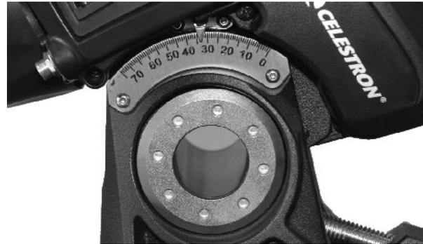
Si está observando desde Los Angeles, que tiene una latitud de 34°, el polo celeste estará a 34° sobre el horizonte norte. Todo lo que hace una escala de latitud es indicar el eje polar del telescopio con la elevación correcta sobre el horizonte norte (o sur). Para alinear el telescopio:
